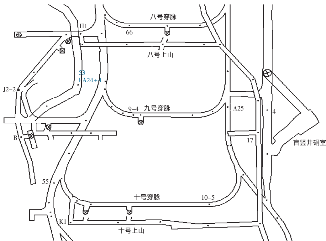
图 3 +420 m 中段局部巷道及巷道导线点
